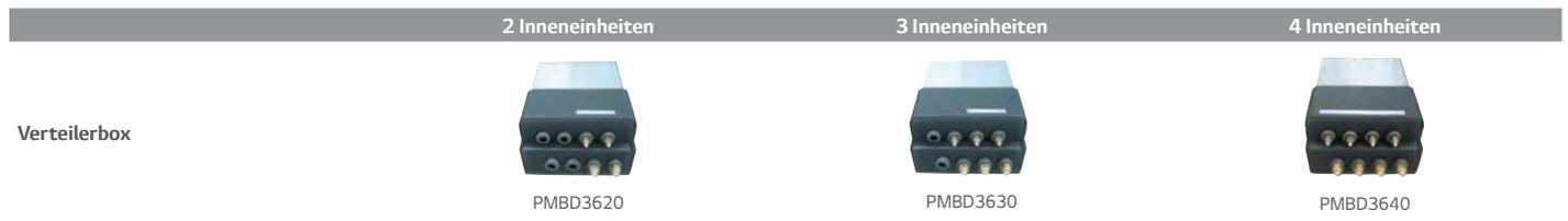
Für eine flexible Installation können an ein Außengerät je nach Baugröße bis zu drei Verteilerboxen angeschlossen werden. Bördelanschlüsse und die kompakte Bauform vereinfachen die Montage. Die bedarfsgerechte Verteilung des Kältemittels wird durch die elektronischen Expansionsventile und die integrierte Steuerungsplatine sichergestellt. Nur zum Anschluss an die MULTI-Außengeräte FMxxAH.
