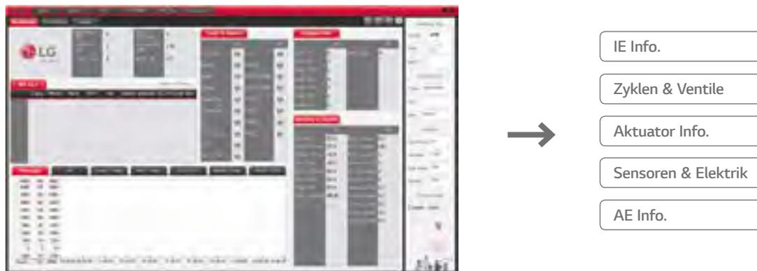
Das LG MV stellt Zyklusinformationen mit Diagrammen zur Verfügung und kann die akkumulierten Daten als Graphen darstellen lassen. Ein Techniker kann einfach den Fehlerstatus überprüfen, indem er die Fehlercodeliste aufruft. (Troubleshooting Guide)
